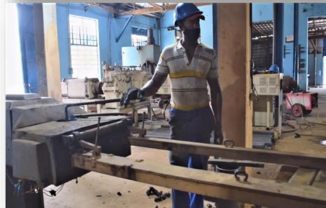
La mezcla realizada con anterioridad se vierte en la máquina extrusora que mediante altas temperaturas va fundiendo y fusionando la materia prima, que luego es inyectada en moldes metálicos de distintas dimensiones según el perfil que se desee conformar. En este paso nacen los perfiles de ECOMADERA.
