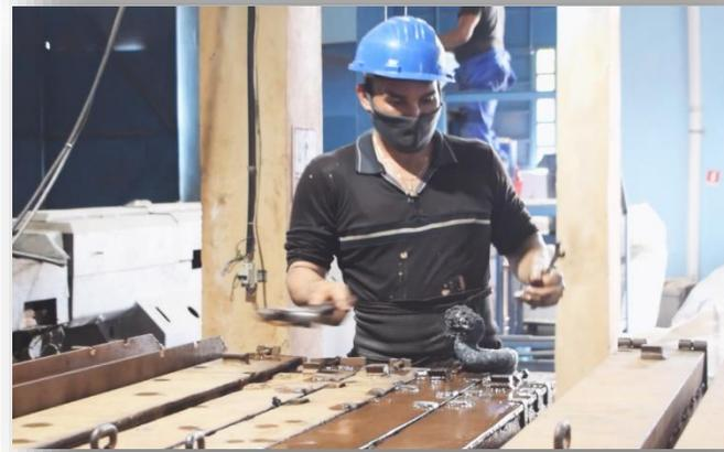
Después de conseguir el enfriamiento parcial de los moldes, estos quedan listos para la extracción manual de los perfiles de ECOMADERA que se encuentran en su interior. Una vez realizado este proceso, los moldes son preparados para volver a ser colocados en la extrusora y continuar con la elaboración de los perfiles.
