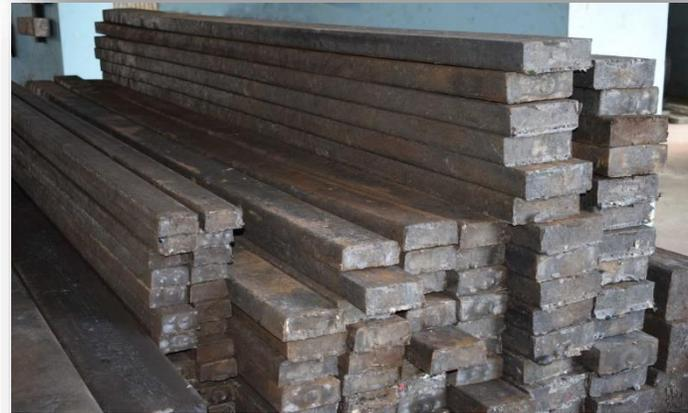
Una vez fuera de los moldes, los perfiles se dejan reposar unas horas hasta conseguir que se enfríen totalmente, de esta manera se evitan las imperfecciones en la estructura de los mismos.
