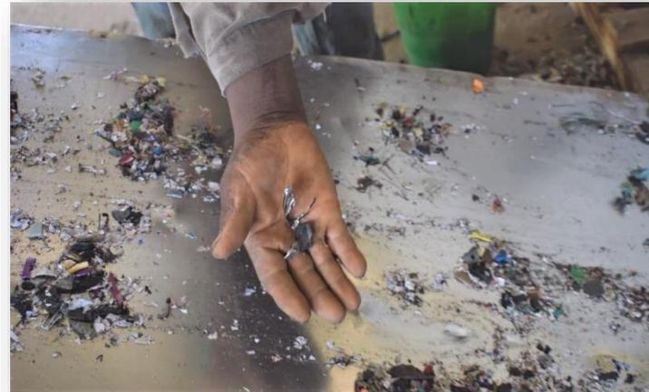
Una vez molido el plástico, resulta necesaria la extracción de los pequeños componentes metálicos que no pudieron ser separados en el proceso de selección, y de permanecer en la mezcla pudieran afectar el funcionamiento de la extrusora y la composición de los perfiles. Para esto es utilizado un electroimán industrial, lo que brinda agilidad y efectividad al proceso.
