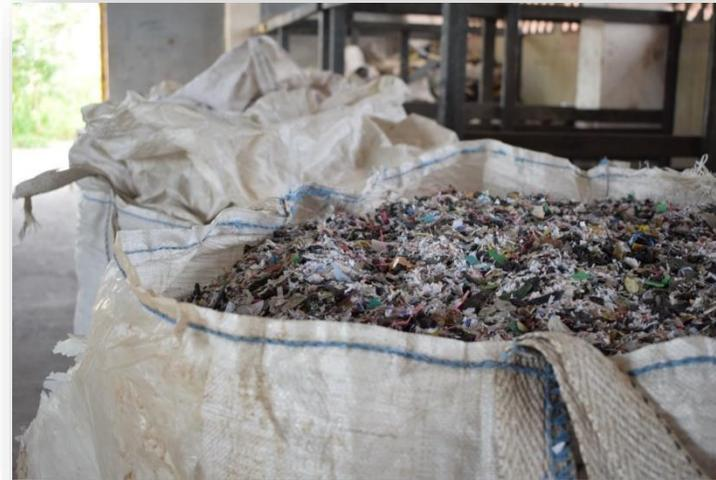
Para la confección de los perfiles entra en juego la selección realizada con anterioridad, pues en este paso se procede a mezclar el plástico por proporciones y según su tipología, ya que todos poseen una temperatura de fundido distinta (lo que otorga el color grisáceo de los perfiles). De esta manera queda conformada la composición de la materia prima que luego pasará al proceso de Extrusión.
