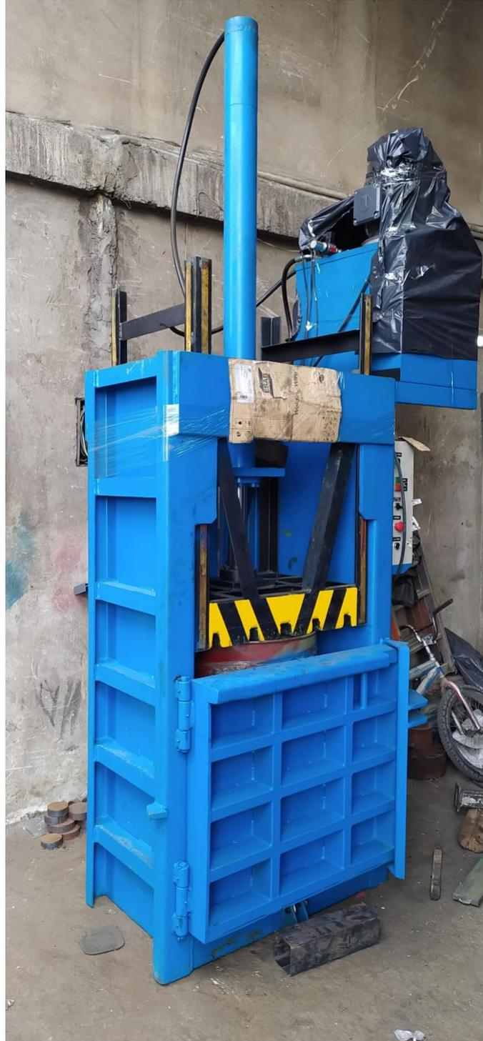
La maquina tiene dos compuertas superiores, para mantener cerrada la inferior cuando se esté terminando la paca y se facilite el llenado.
