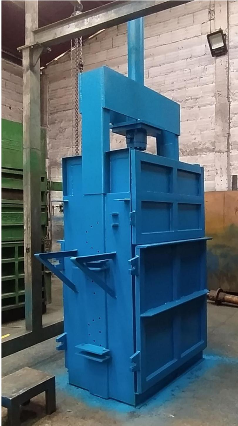
**La maquina tiene dos compuertas superiores, para mantener cerrada la inferior cuando se esté terminando la paca y se facilite el llenado.**
