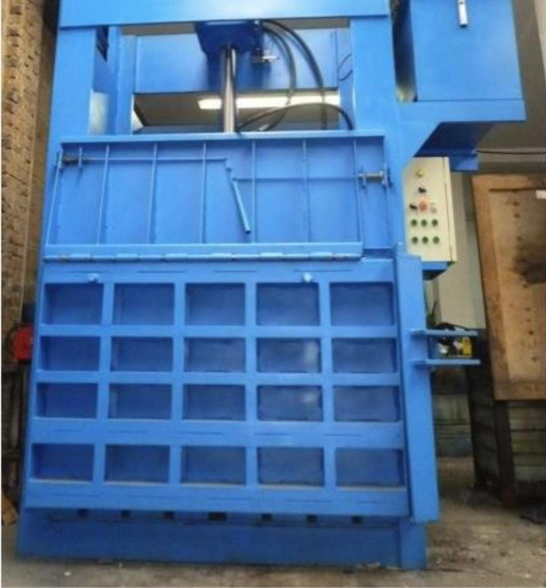
**La maquina tiene dos compuertas superiores, para mantener cerrada la inferior cuando se esté terminando la paca y se facilite el llenado.**
